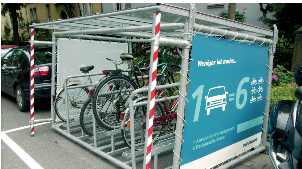
Überdachte, mobile Abstellanlage in der Grazer Innenstadt. Dieser Prototyp wurde von der Stadt Salzburg, Baudirektion/MA 6, entwickelt und von der Stadt Graz, Abteilung Verkehrsplanung, gebaut.
