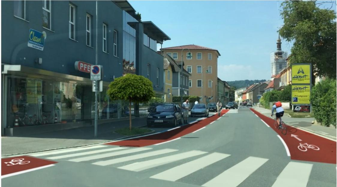
Abbildung 4-10: Beispiel für fehlende Infrastruktur -> Mehrzweckstreifen-Variante zwischen Bahnhof Leibnitz und dem Zentrum (Visualisierung PLANUM)
