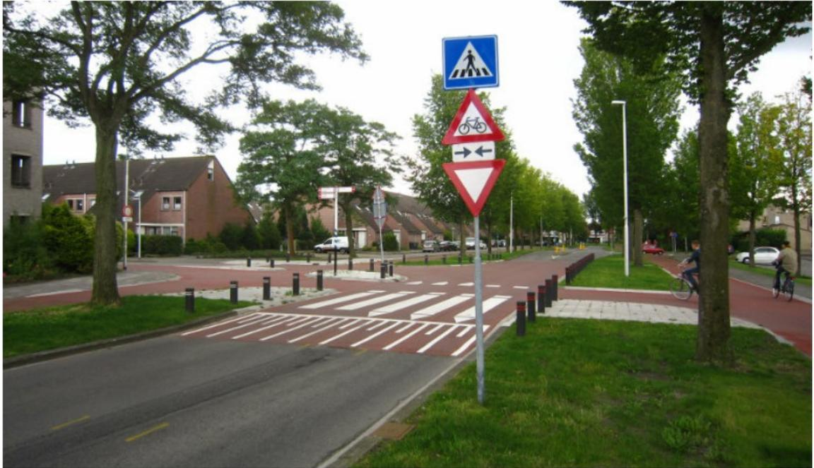
Abbildung 5-1: Beispiel einer bevorrangten Querung für den Radverkehr in den Niederlanden
